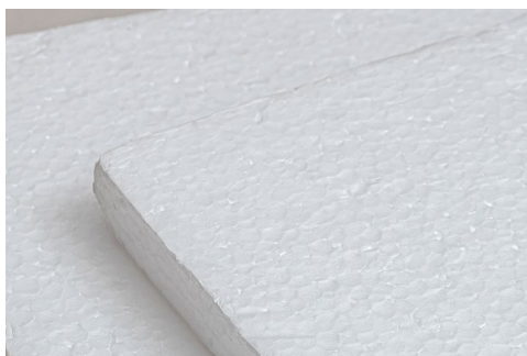
XPS / Porexpan necessita de fixações ou cimentos adicionais
